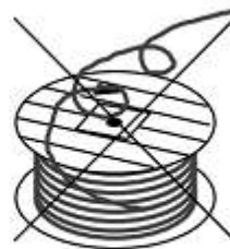
Неправилно одмотување на кабел
