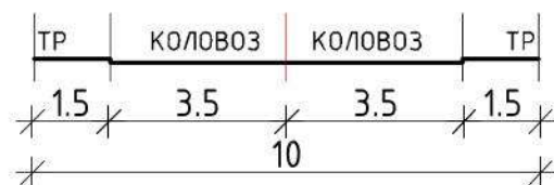
ПОПРЕЧЕН ПРОФИЛ НА НОВОПЛАНИРАНА УЛ.1 - ТИП ИНДУСТРИСКА УЛИЦА, пресек 5-5
